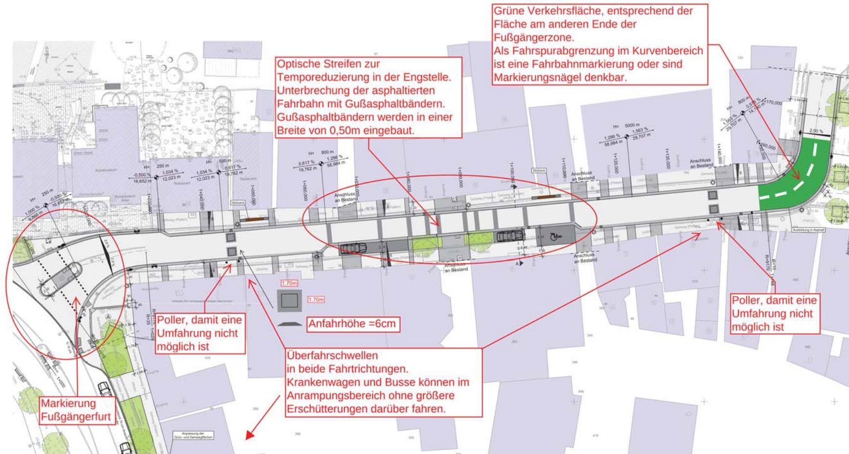
Optische Streifen zur Temporeduzierung in der Engstelle. Unterbrechung der asphaltierten Fahrbahn mit Gußasphaltbändern. Gußasphaltbändern werden in einer Breite von 0,50m eingebaut.
